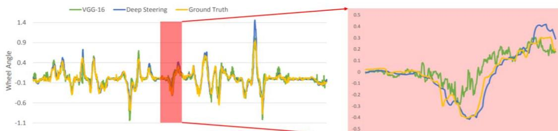
Ilustración 30 Gráfica comparativa entre ground truth producido por humano y valores de dos CNNs. Extraída de [27]
