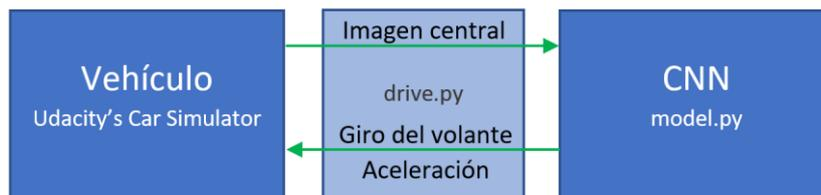
Ilustración 14 Comunicación entre simulador y CNN
