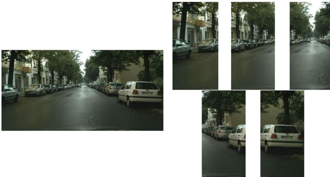
Figura 2.6: División de las imágenes de test para solventar problemas de limitación de memoria. Nótese el solapamiento existente entre ellas para el evitar efecto borde.
