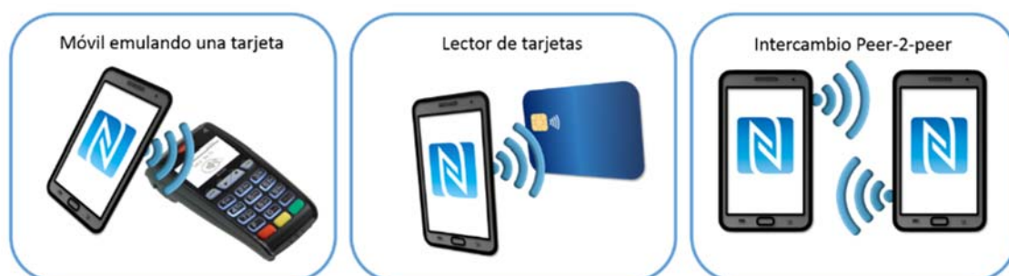
Figura 4.16: Tipos de funcionamiento del dispositivo NFC.
