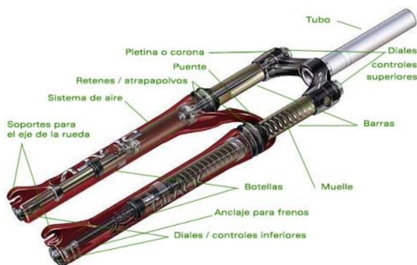
**Figura 4. Partes de una horquilla.**
