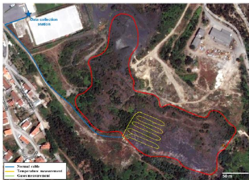
Fig. 2.14: Vista aérea de Sao Pedro da Cova, y de la pila de desechos de carbón en combustión (zona rodeada en rojo) así como el esquema de tendido del cable de fibra óptica (en amarillo).
