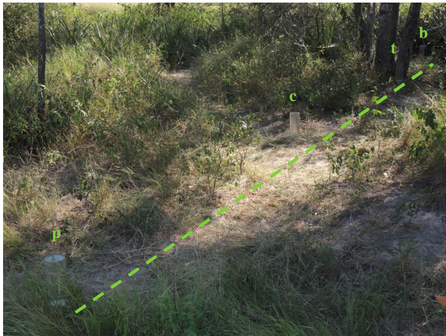
Figura 8: Implementación del diseño experimental. ensayo de infiltración dentro del bosque (b), en la base del tronco (t), en la proyección de la copa del árbol sobre el pasto (c) y en el pasto (p)
