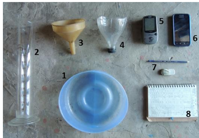
Figura 10: Materiales empleados en los ensayos de evaporación. 1) Tanque evaporímetro, 2) Probeta de 500 ml, 3) Embudo, 4) Enrasador, 5) GPS, 6) Reloj, 7) Lápiz y goma, 8) Cuaderno de campo.
