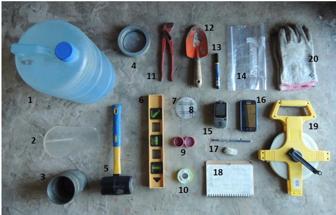
Figura 9: Materiales empleados en los ensayos de infiltración. 1) Garrafa, 2) Infiltrómetro, 3) Tubo auxiliar, 4) Tapa metálica, 5) Maza de goma, 6) Nivel, 7) Rejilla de fondo, 8) Horquillas, 9) Grasa, 10) Teflón, 11) Mordaza, 12) Palita, 13) Rotulador, 14) Bolsa con cierre hermético, 15) GPS, 16) Cronómetro, 17) Lápiz y goma, 18) Cuaderno de campo, 19) Cinta métrica, 20) Guantes.
