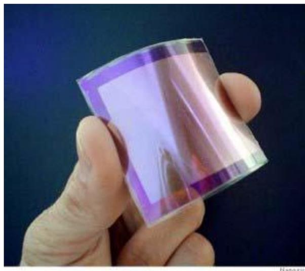
Figura 1.12 Célula solar de segunda generación
