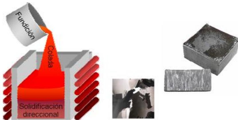
Figura 1.15 Cristalización del silicio multicristalino
