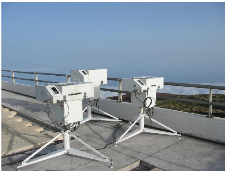
Fig.3.5 Imagen de tres espectrofotómetros Brewer en Izaña (Tenerife). Foto A. Redondas
