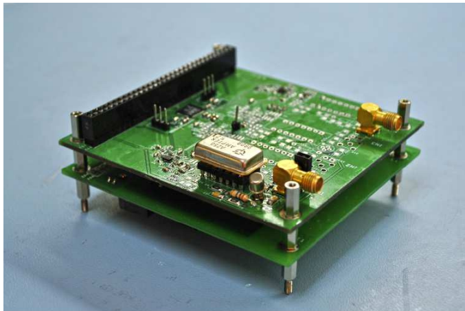
FIGURA 6.2. Tarjeta de adquisición de datos y tarjeta de potencia apiladas.
