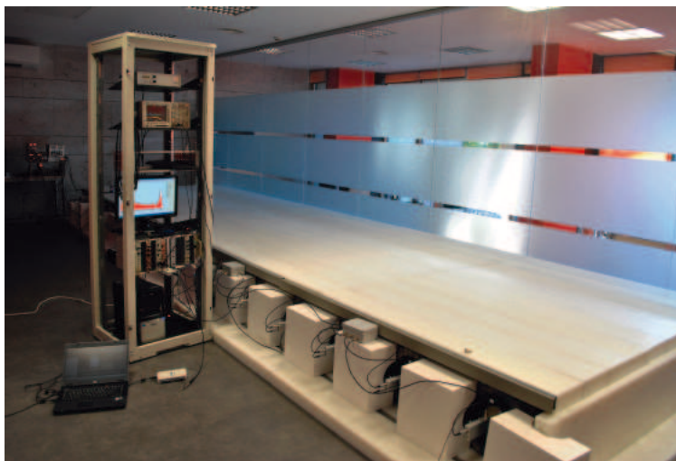
FIGURA E.2. Monitor de neutrones y setup del experimento.
