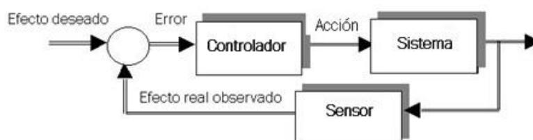
**Figura 1.1.** Esquema controlador básico.
