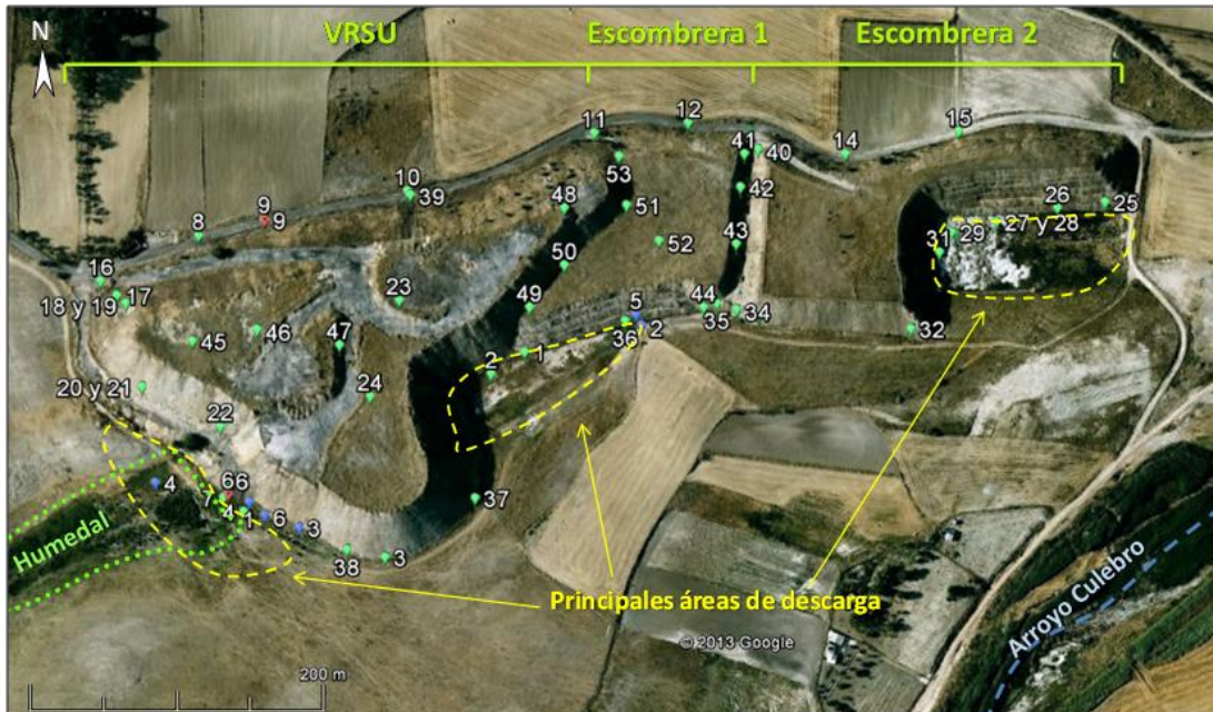
Fig 4. Representación de las zonas más importantes del vertedero y localización de los sitios de recogida de muestras del suelo de sellado. Imagen Google Earth de fecha 8/3/2007, coordenadas UTM: X=442599 Y=4459459, 30T. Los números corresponden al orden en que fueron recogidas las muestras de suelo
