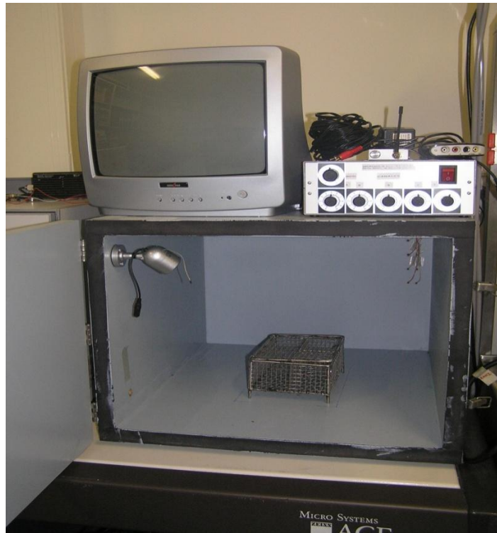
Figura 11. Imagen de la cámara de ruido utilizada en el experimento. Incluye una jaula de colocación del animal, una cámara de video con visión infrarroja, un amplificador multicanal, y unos altavoces. Siempre se utiliza un sonómetro y un calibrador de sonido para comprobar y verificar la intensidad del ruido que se aplica.
