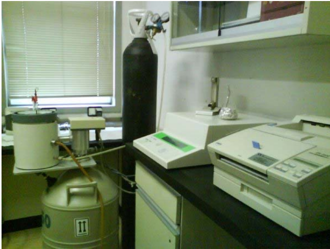
Fig. VII.1: Fotografía del calorímetro diferencial de barrido Mettler TA 4000
