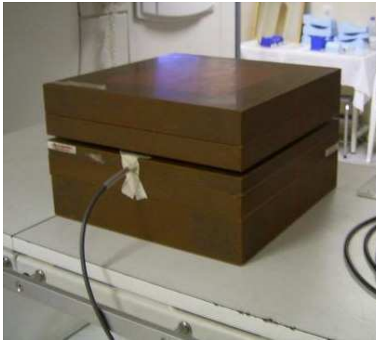
Figura 3.5: Maniquí de agua sólida utilizado para irradiar los dosímetros termoluminiscentes en campos de tamaño estándar.
