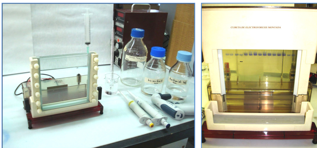
❖ Figura 3. 4: A la izda., el aparataje y productos para la preparación de geles de poliacrilamida. A la dcha. cubeta de electroforesis montada
