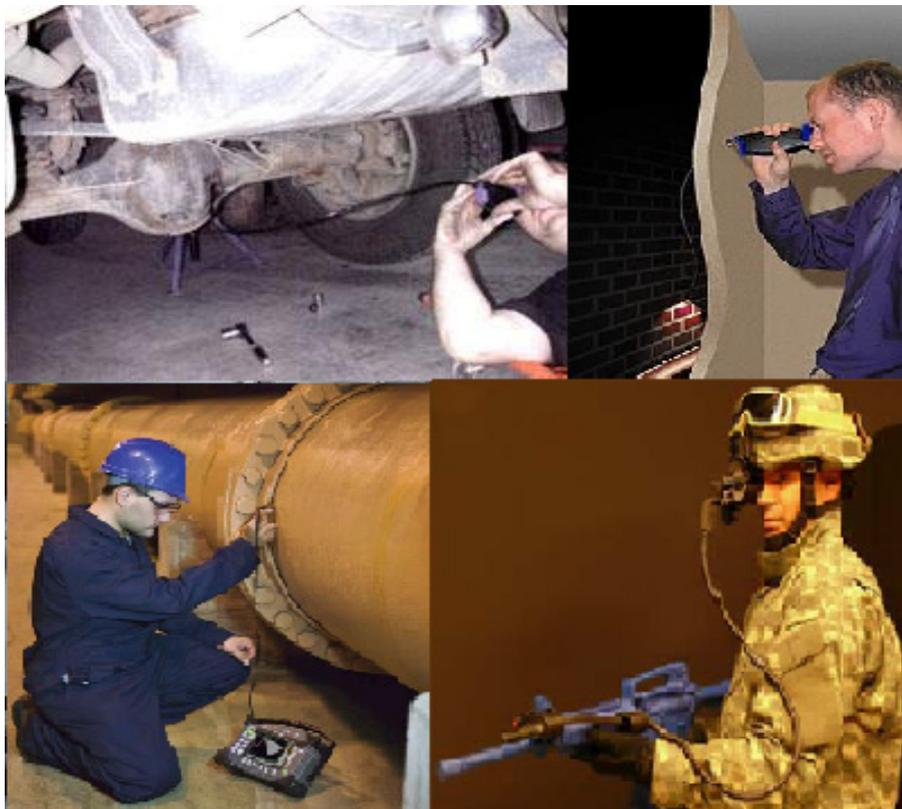
**Figura 2.2. Ejemplos que muestran algunas aplicaciones de los mazos de fibras en la transmisión de imágenes.**
