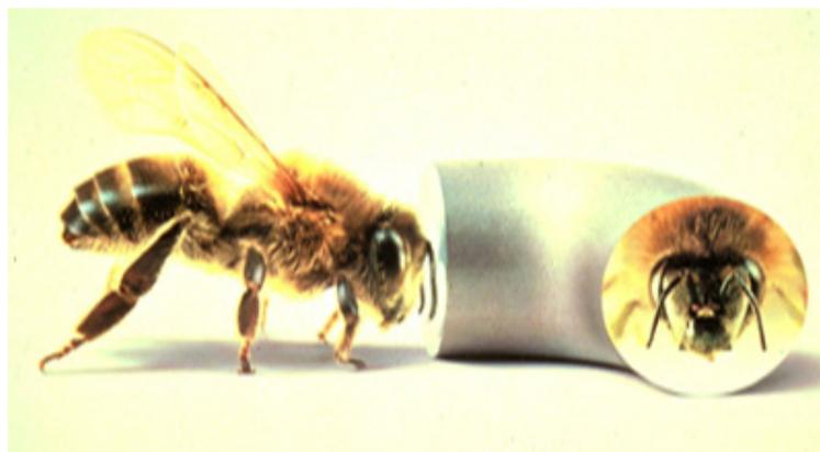
Figura 1.2. Ejemplo real de transmisión de imágenes por mazos de fibras coherentes.
