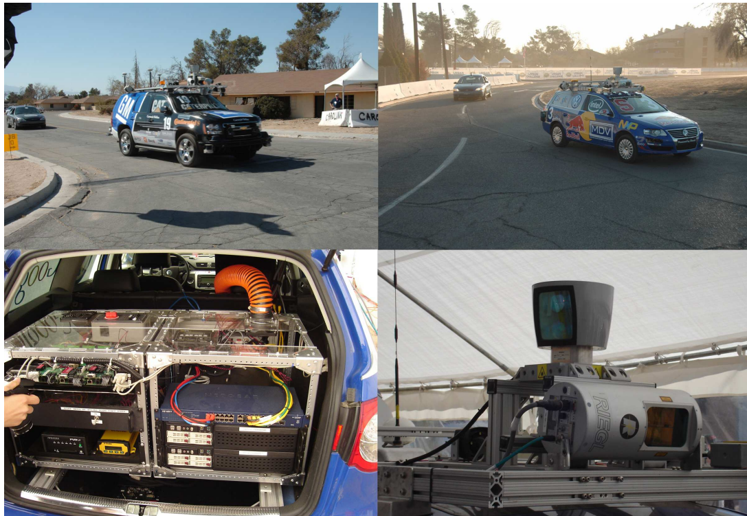
Figura 1.1: Imagen superior : Vehículos autónomos participantes en la carrera DARPA Urban Challenge. Imagen inferior : Hardware de control y sensores de distancia láser empleados en uno de los vehículos participantes.
