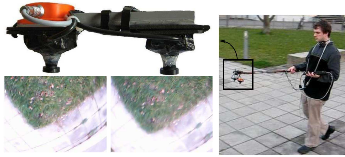
Figura 2.26: Sistema estéreo empleado en las pruebas del sistema, constituido por dos cámaras web y un sensor inercial de bajo coste.
