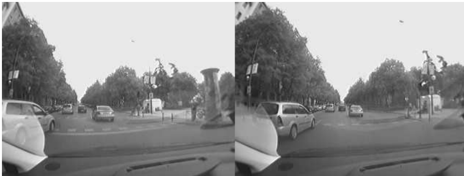
(b) Secuencia que muestra dos instantes en los que un vehículo en movimiento, a la izquierda de la imagen, circula a una velocidad cercana a la del vehículo de pruebas y en el mismo sentido. Esta situación incumple la suposición de un entorno estático.
