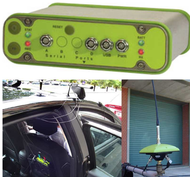
Figura 6.10: RTK-GPS utilizado como referencia. Abajo a la izquierda: Ubicación del RTK-GPS dentro del vehículo de pruebas. Abajo a la derecha: Antena receptora de señal GPS + correcciones de posición vía radio.
