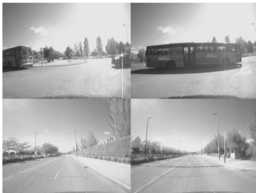
Figura 6.17: Causas del error de estimación en el último tramo. En las imágenes superiores se observa la oclusión casi total de las mismas por parte de un autobús. En las imágenes inferiores se muestra el entorno del último tramo tras la oclusión, en el que se aprecia la ausencia casi total de texturas donde extraer marcas visuales relativamente cercanas.
