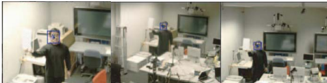
Figura 2.14. Resultados del seguimiento de una persona arrojados por el estimador presentado en [Kobayashi06] en un instante de tiempo. Las imágenes muestran la captura de la escena obtenida desde tres de las cámaras usadas como sistema de adquisición. El cuadrado azul muestra la posición estimada del objeto en ellas.
