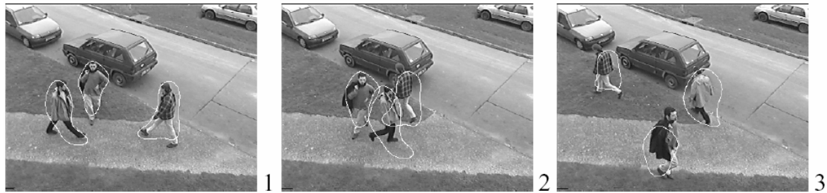
Figura 2.24. Resultados extraídos de [Hue01], en la aplicación del algoritmo ahí descrito al seguimiento de tres personas. Se muestran tres imágenes de la secuencia de video de prueba.
