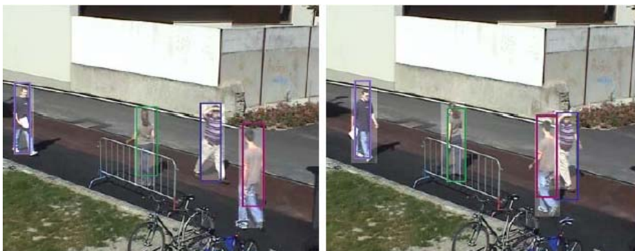
Figura 2.25. Resultados obtenidos en la aplicación del algoritmo propuesto en [Smith05]. La estimación de posición arrojada por el filtro para cada persona se marca con un rectángulo de color.
