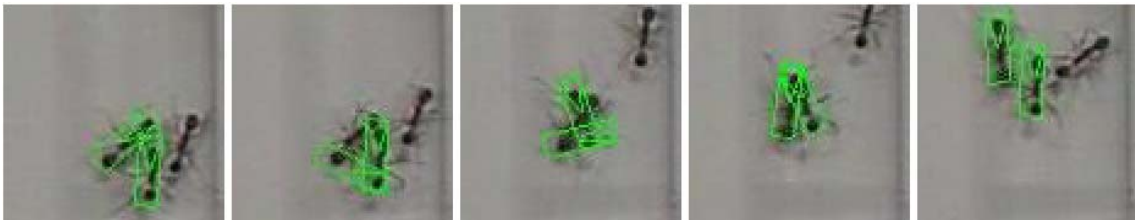
Figura 2.18. Resultados obtenidos mediante el algoritmo de MTT presentado en [Khan03]. Los cuadrados verdes marcan la posición y orientación del movimiento (marcado por el triángulo verde interior) de las dos hormigas que interaccionan y son objeto de seguimiento en distintos momentos del experimento.
