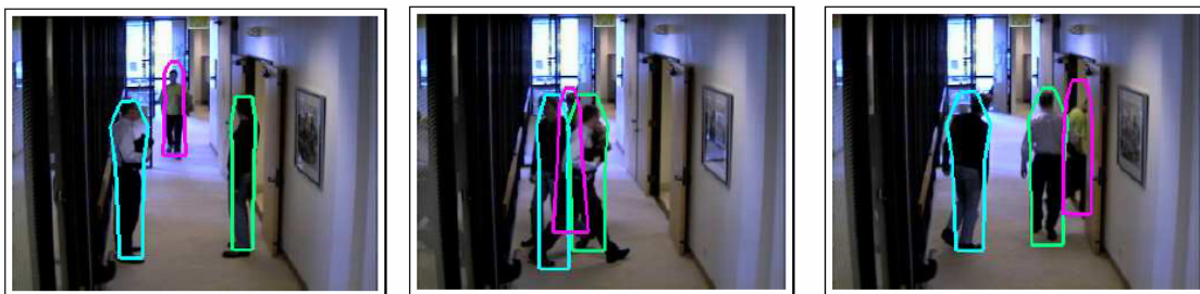
Figura 2.22. Resultados del sistema de seguimiento planteado en [Isard01]. Los polígonos de color indican la estimación de posición arrojada por el algoritmo en diferentes instantes de la secuencia de prueba global.
