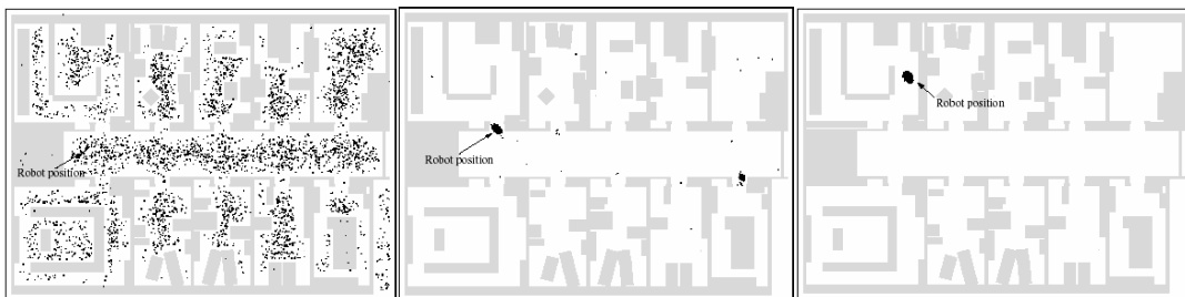
Figura 2.7. Ejemplo de funcionamiento de un localizador de Monte-Carlo. Las imágenes representan momentos consecutivos del proceso de localización de un robot dentro de un mapa conocido a priori. Los puntos negros (que se van concentrando según se va incrementando la certeza de la posición del robot) representan a las partículas del PF. Extraído de [Doucet01].
