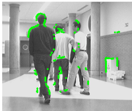
Figura 5.2. Imagen de la escena real de la que se extrae el set de medidas Y representado en la Figura 5.1. La proyección del conjunto en el plano imagen se muestra en verde.
