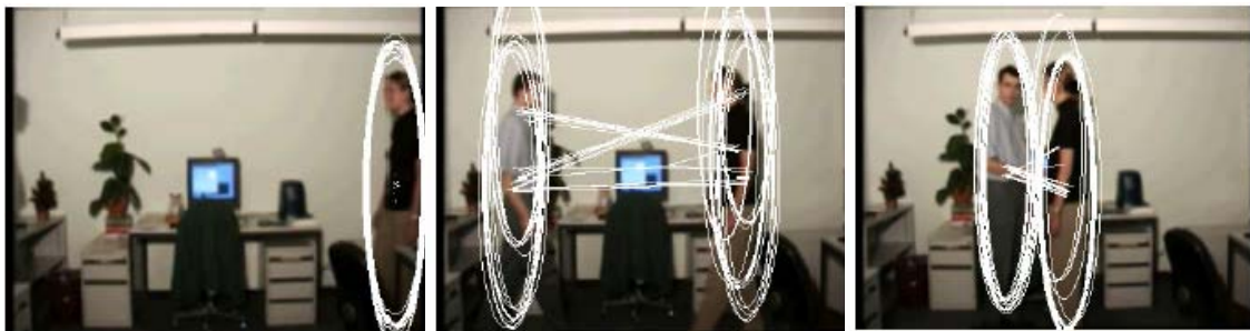
Figura 2.21. Resultados obtenidos con el algoritmo presentado en [Spengler03] en el seguimiento de dos personas. Las elipses blancas muestran la posición en la imagen del objeto seguido y las líneas blancas indican el estado del modelo de interrelación usado.
