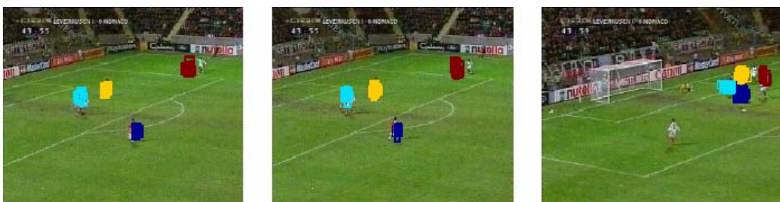
Figura 2.26. Resultados del algoritmo de MTT descrito en [Vermaak03]. Cada jugador objeto del seguimiento se marca en un color diferente en las imágenes con tantos rectángulos como partículas asociadas a él haya en la mezcla de componentes.
