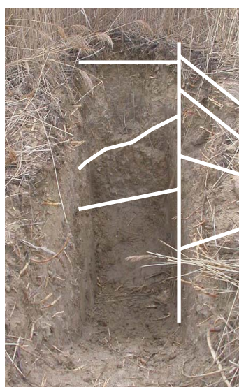
Figura 1. Alteración del suelo producida tras la transformación en regadío y la aparición posterior de nuevos horizontes orgánicos como consecuencia de la presencia de humedales.
