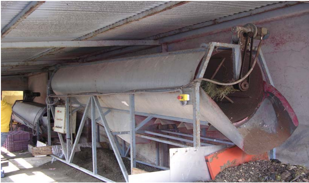
Fig. 6. Rodillo con sistema de filtros gruesos para el cribado de larvas de Asticot.
