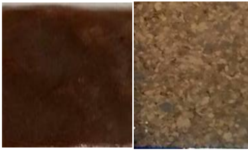
Gambar 8. Komposit serat bambu (kiri) dan pulp bambu (kanan)
