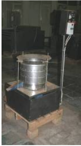
Gambar 5. Mesin Ayakan Sabut Kelapa
