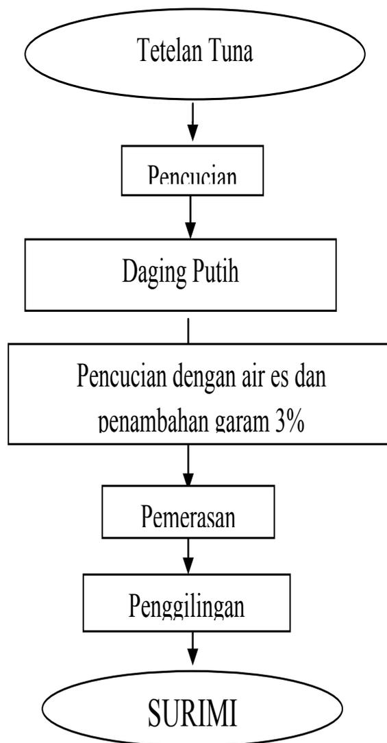
Gambar 1. Diagram alir proses pembuatan surimi ( Park, 2008 yang dimodifikasi )
