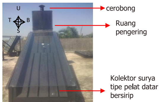
Gambar 1. Pengerik Surya Tipe Kolektor Pelat Datar-Dengan 9 Buah Sirip
