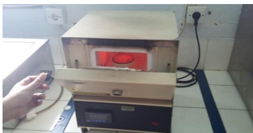
(b) Proses pelunakan sesuai variasi temperatur (800, 900 dan 1000°C)
