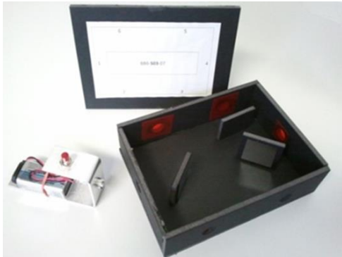
Abb. 2: Optische Blackbox (geöffnet) mit Lichtquelle
