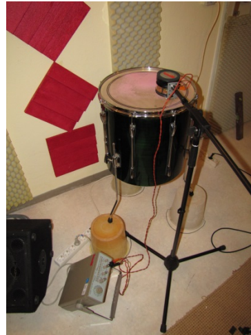
Abb. 10: Versuchsaufbau für Klangfiguren auf dem Trommelfell
