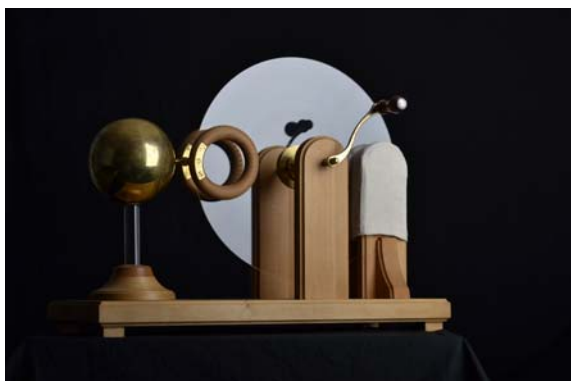
Abb.1: Verwendeter Nachbau der Scheibenelektriermaschine
