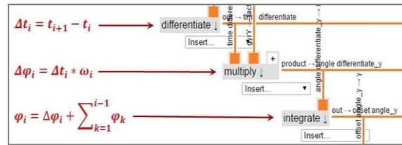
**Abb. 6:** Ausschnitt aus der „Analysis“ des *phyphox* Editors zum harmonischen Fadenpendel. Aus der Differenz aufeinanderfolgender Zeitdaten und den dazugehörigen Daten des Gyrometers wird die Winkeldifferenz zwischen zwei Messpunkten ermittelt. Deren Addition ergibt einen harmonischen Verlauf der Winkeländerung.
