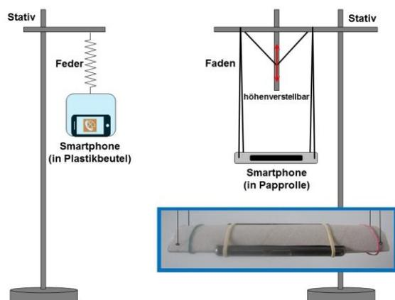
**Abb. 3:** Schematische Aufbauten der Smartphone-Experimente zu den harmonischen Pendelschwingungen. Links: Bei dem Federpendel ist das Smartphone in einem Plastikbeutel platziert, der an der Feder befestigt wird. Rechts: Der Versuchsaufbau des Fadenpendels wurde durch eine Schaukel realisiert. Als Halterung für das Smartphone dient ein Hohlzylinder aus Pappe.
