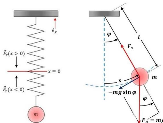
**Abb. 1:** Schematische Darstellung eines ungedämpften harmonischen Oszillators mit Ruhelage bei  $x = 0$  (links) und einer Pendelschwingung mit den Kräften, die auf die Pendelmasse  $m$  wirken (rechts).
