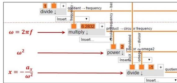
**Abb. 2:** Ausschnitt aus der „Analysis“ des *phyphox* Editors zum harmonischen Federpendel. Mit den Daten des Beschleunigungssensors  $a_x$  und der Frequenz  $f$  wird über das Beschleunigungsgesetz der harmonischen Schwingung die Elongation  $x$  in x-Richtung berechnet.
