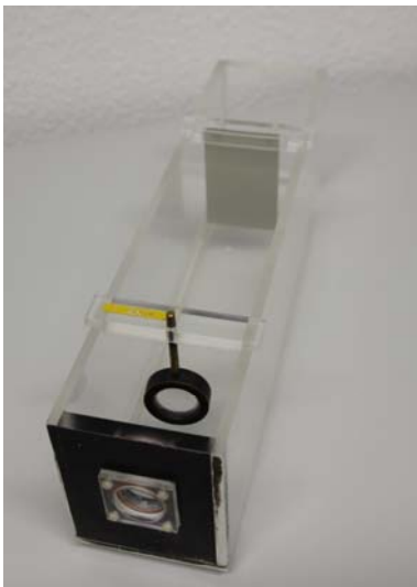
Abb. 21: Das Augenmodell für die Simulation von Fehlsichtigkeiten. Linse und Schirm sind beweglich.
