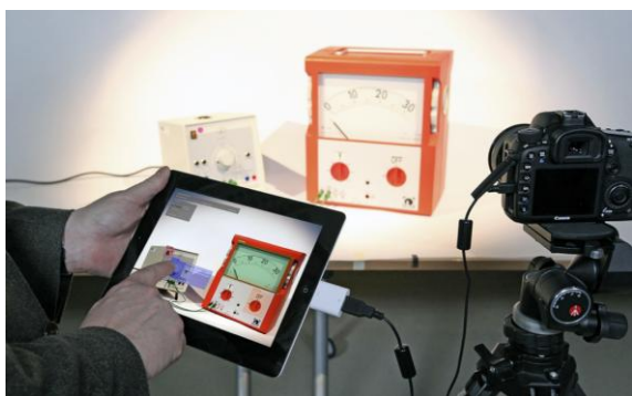
Abb. 6: Der „IBE-Assistent“ ermöglicht die Herstellung eines IBE über eine intuitiv bedienbare Oberfläche. Das Bild zeigt eine Variante, bei der eine externe Kamera vom Assistenten gesteuert wird. Die Bilder werden automatisch entsprechend der vom Nutzer festgelegten Eigenschaften des IBE verarbeitet und in einem vom Endgerät unabhängigen Format online bereitgestellt.
