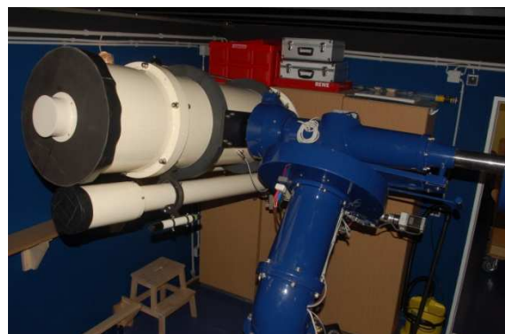
Abb. 2: Das 12,5"-Newton-Cassegrain-Teleskop neben dem 110mm-Achromat-Refraktor auf der schweren Zeiss-Montierung
