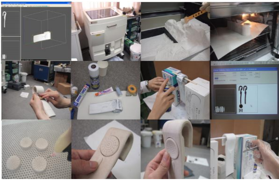
Fig.4 RPでのモデル造形と後処理
