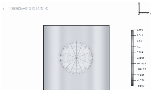
図 12 . 半径 25[mm] 導体表面の磁界 ( H_x )
