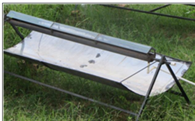
ColdRolled de 220 centímetros de largo con un diámetro de 10 centímetros.
