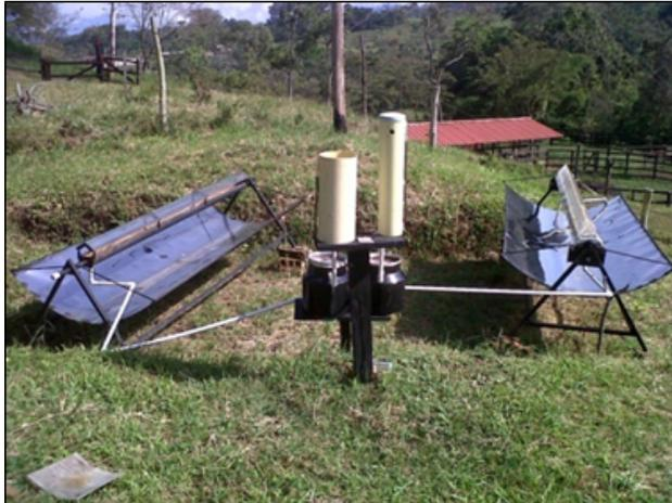
El concentrador de Evaporación Directa está compuesto por un tubo PVC de 6" con diámetro interno de 15 cm y una altura de 45 cm, el recipiente de destilación es un tubo PVC de 4" con diámetro interno de 10 cm y una altura de 28 cm, se marcó el nivel de entrada donde se adecuó una manguera transparente para realizar la medición de variación en nivel.
