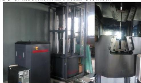
Gambar 2. Universal testing machine dan proses pengujian tarik
