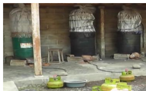
Gambar 1. Sterilisasi Baglog dengan Drum Bekas Oli
