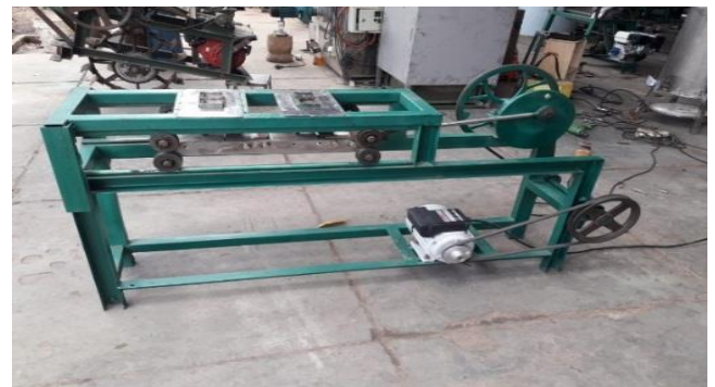
Gambar 2. Mesin Perajang V-Cutting Hasil Perancangan
