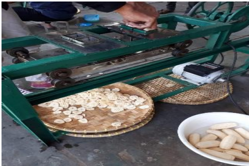
Gambar 3. Uji Unjuk Kerja Mesin Perajang
