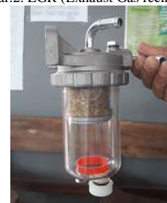
Gambar.3. EGR modifikasi dengan filter serat kedelai edamame
