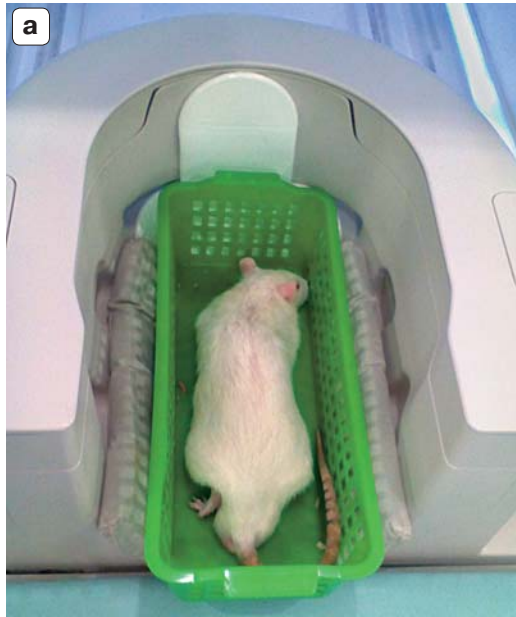
Рис. 2. Методика визуализации миокарда крысы при МРТ с Mn-МИБИ. а – расположение крысы в квадратурной катушке для исследований головы и шеи. Наркотизированные ( ® Телазол, 0,1 мг/1 кг массы тела внутримышечно) животные находились в немагнитной свободно вентилируемой лежанке в положении на животе так, чтобы сердце находилось в изоцентре магнитного поля томографа; б – расположение аксиальных томографических срезов МР-томограмм сердца крысы при МРТ-исследовании с парамагнитным контрастным усилением с Mn-МИБИ. Срезы толщиной по 2,5 мм, полностью охватывающие объем грудной клетки.
