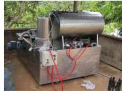
Gambar 2. Unit penggoreng vakum sistem *water jet*
