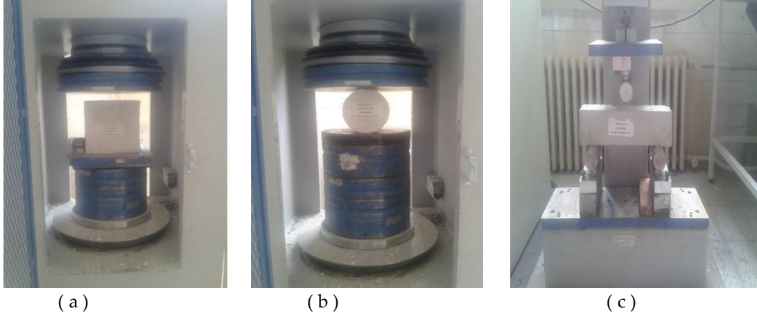
Şekil 1. (a)Basınç dayanımı deney düzeneği, (b) Yarmada çekme dayanımı deney düzeneği (c)3 nokta eğilme dayanımı deney düzeneği
