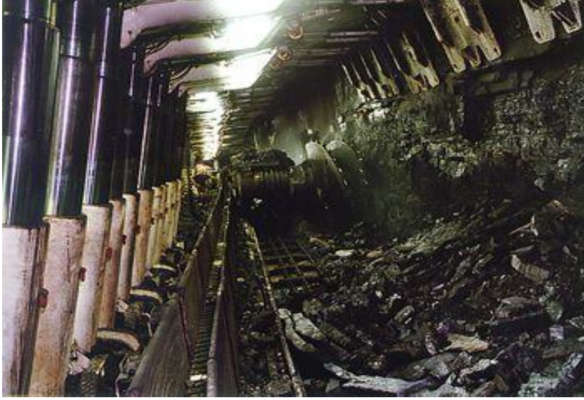
Şekil 3. Tamburlu kesici-yükleyici ve yürüyen tahkimatların görünüşü ( View of drum shearer-loader and roof supports ) ( http://eis.uow.edu.au/longwall/html/shear_photo.html )
