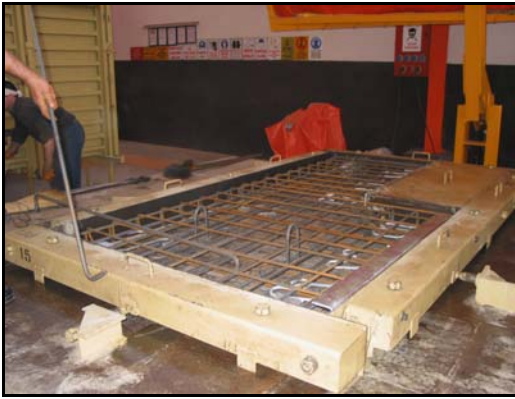
Resim 9. Prekast atölyesinde sahanlık üretiminin gerçekleştirilmesi.
