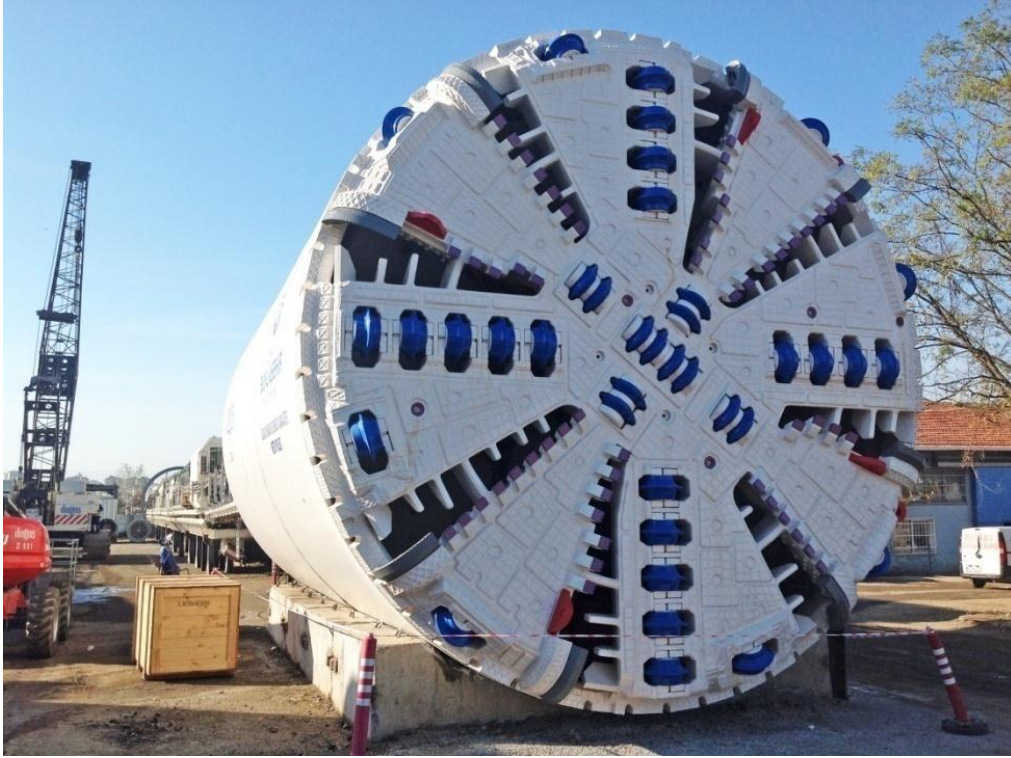
Şekil 4. Projede kullanılan EPB-TBM (EPB-TBM used in the project)
