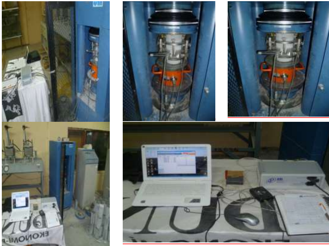
Şekil 1. Elastisite modülü belirlemede kullanılan deney düzenegi
