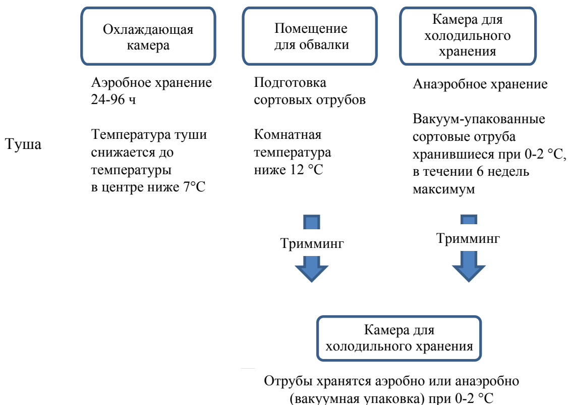
Рис. 2. Условия охлаждения и холодильного хранения туш КРС, свиней и МРС, и их сортовых отрубов и тримминга (адаптировано из [3])
