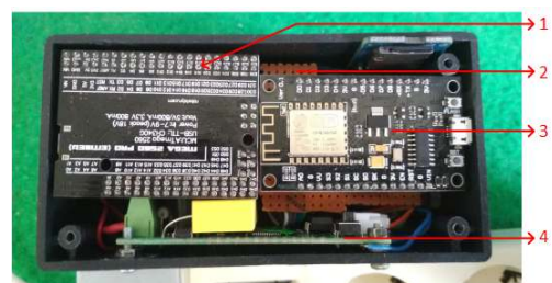
Gambar 2 Hasil Perakitan Alat Kontrol & Monitoring Konsumsi Listrik
