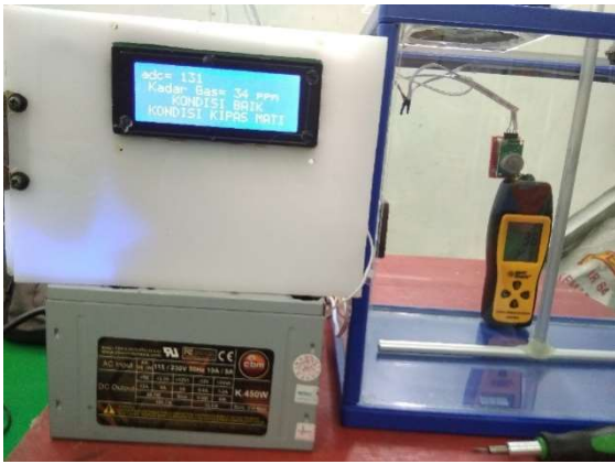
Gambar 5 Tampilan pada saat mendeteksi kadar gas karbon monoksida
