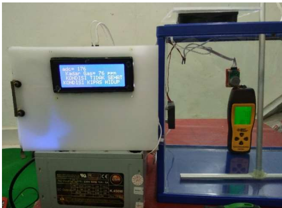
Gambar 6 Tampilan pada saat mendeteksi kadar gas karbon monoksida kurang baik.
