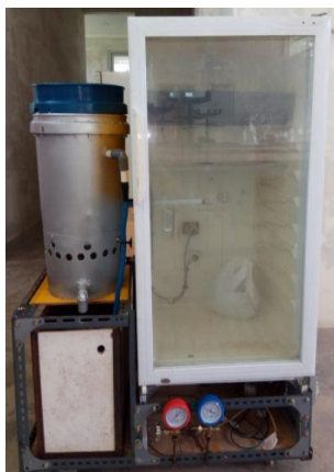
Gambar 7 Mesin mini pengkondisian udara tipe water cooled condenser
